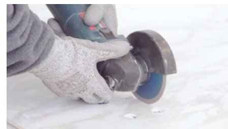
Smerigliatrice angolare con disco diamantato / Diamond-blade angle grinder
