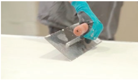
Spatola con denti da 3mm / 3mm-tile trowel
